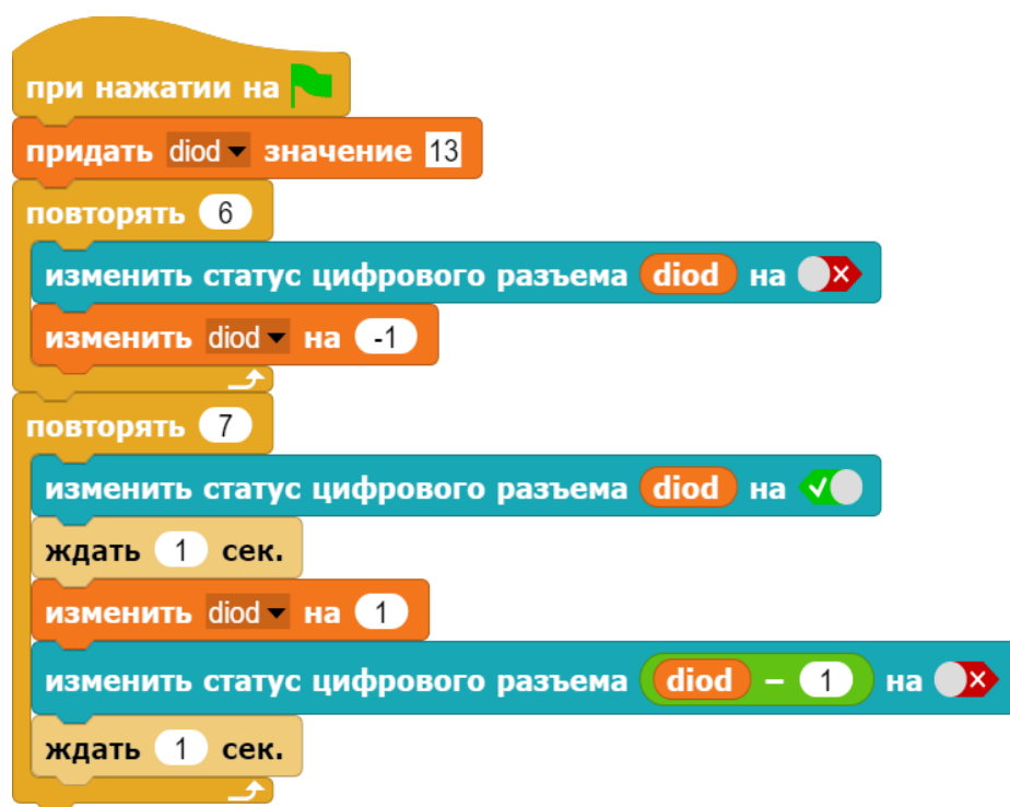
Рис. 15. Возможная программа имитации эффекта «бегущего огня» для пяти светодиодов с использованием переменных
