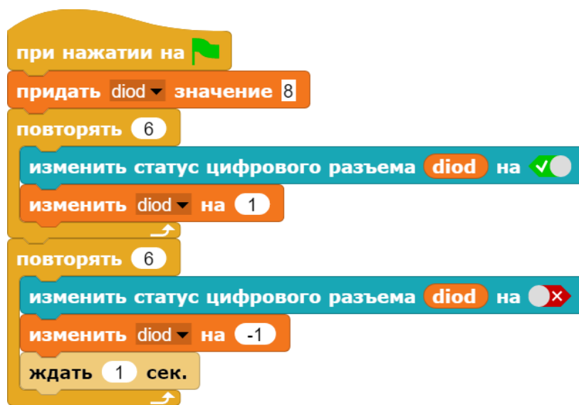
Рис. 12. Возможная программа имитации эффекта «гаснущего огня» для пяти светодиодов с использованием переменных
