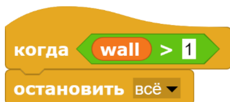
Рис. 22. Изменения в программе для прохода вдоль одной стены
