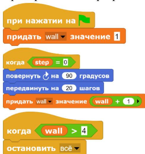
Рис. 20. Изменения в программе виртуальной модели робота, обходящего стены внутри один раз
